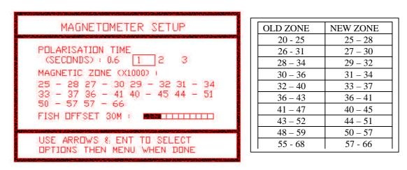
THE ABOVE DIAGRAM SHOWS THE ACTUAL MAGNETIC ZONE VALUES THAT SHOULD BE INTERPRETED FOR THE EQUIVELENT MENU SELECTION 7.2 POLARISE TIME
